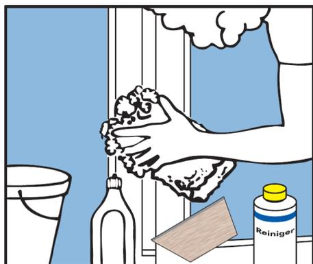
Le nettoyage et l'entretien sont extrêmement facilités par le fait que les profilés pour fenêtre en PVC soient parfaitement lisses et que la coloration soit dans la masse. Pour le nettoyage de vos fenêtres, nous vous recommandons d'utiliser de préférence un produit à vaisselle ou un savon de ménage courant. Les fenêtres en PVC ne sont pas à l'abri des salissures dues à la poussière ou à la pluie.
