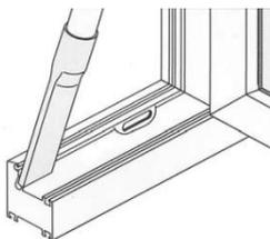
Passer avec soin l'aspirateur dans le fond de feuillure et nettoyer les lumières de drainage à l'aide d'une tige en bois ou en PVC.
